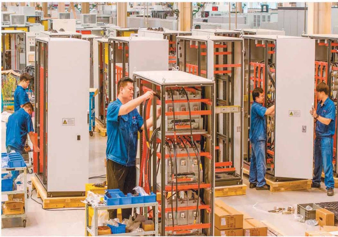
近年来,河南省洛阳市伊滨区聚焦智能装备、储能产品等领域,加强研发创新支持力度,推动当地高新技术企业不断成长壮大,助力区域经济高质量发展。图为位于伊滨区的洛阳中重自动化工程有限责任公司车间内,工人加工组装矿用高压变频控制柜。
