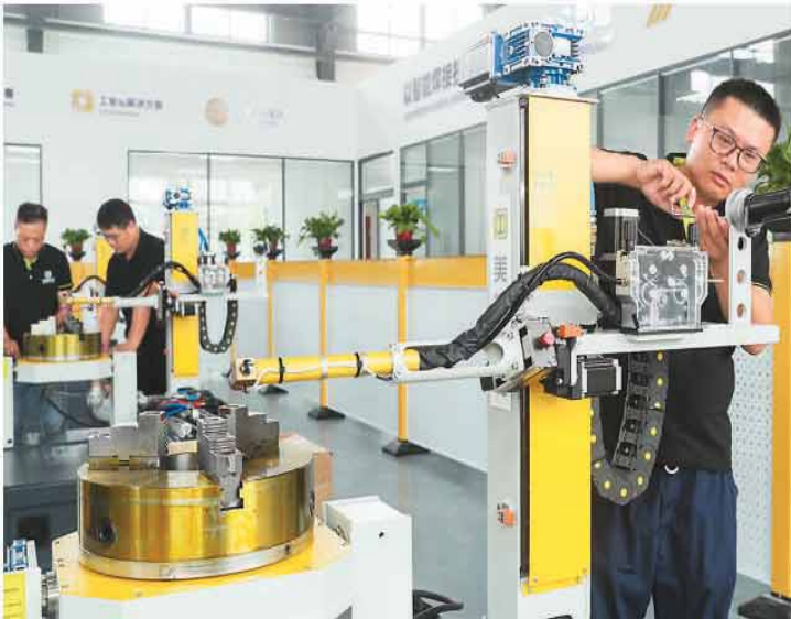
7月19日,在江苏省淮安市清江浦区的一家机器人制造企业车间内,工人安装调试智能焊接机器人。
