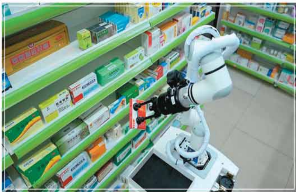
左图：穹御自研L1单臂移动机器人可直接零改造嵌入原有药房环境，接入真实订单系统，已实现无人药房线下实地运营。
