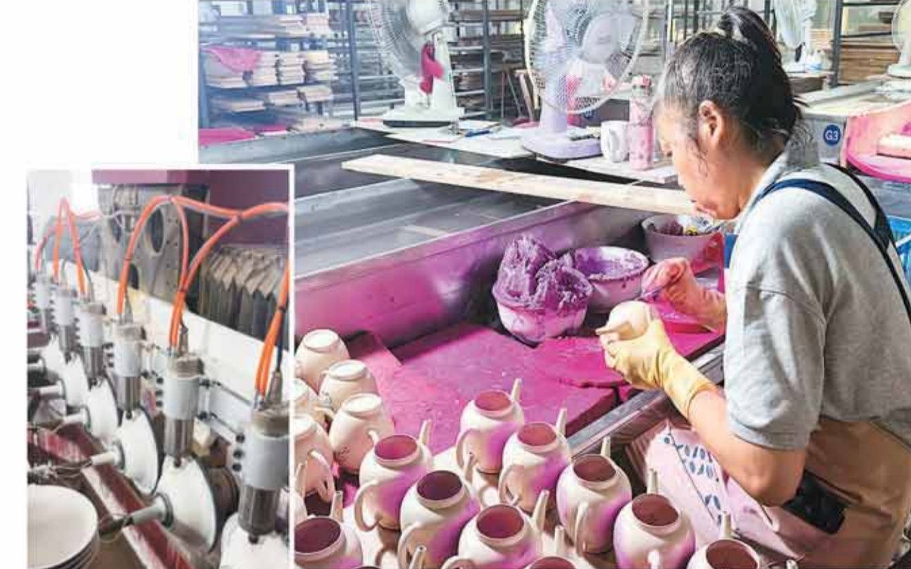
▲富玉陶瓷生产车间里，工人正在手工上釉制坯。 ▲标准化设备正在进行玲珑眼雕镂。 ▼展出的富玉陶瓷玲珑瓷产品。
