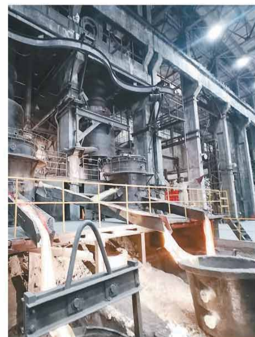
图为沈阳工业博物馆展出的十吨冲天炉。
