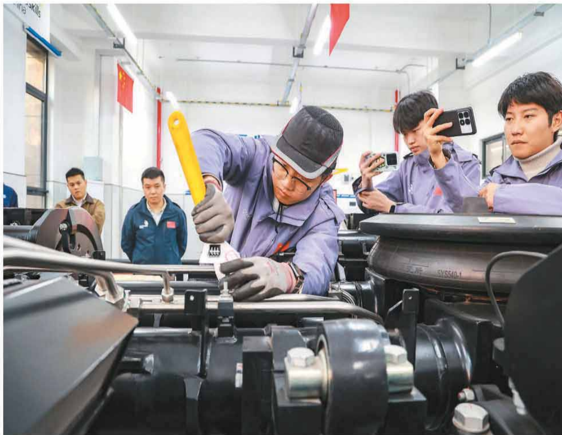
▲ 第48届世界技能大赛轨道车辆技术项目中国集训队在浙江交通技师学院开展技术交流。图为队员在进行车辆转向架检修操作。
