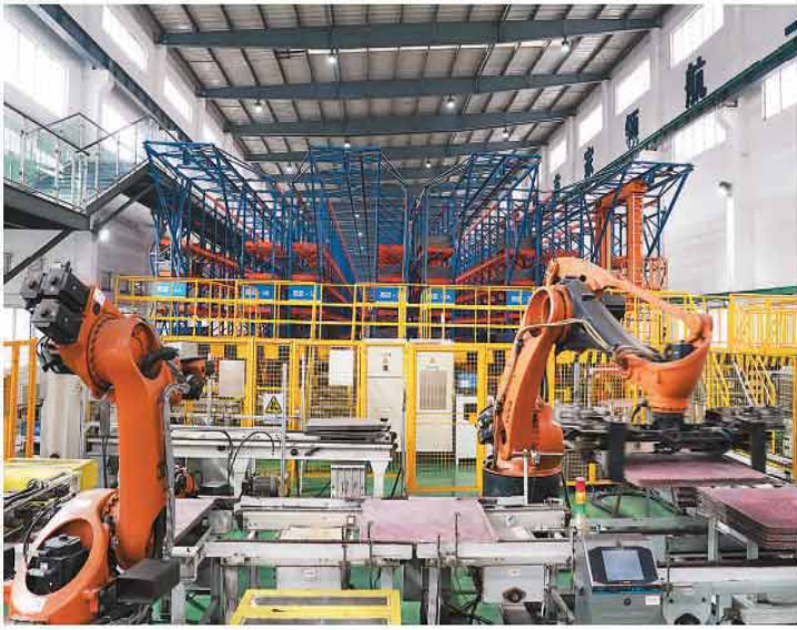
位于江西省的江铜集团贵溪冶炼厂智能化电解车间内，机器臂进行钢板转运作业。 新华社记者 万 象摄
