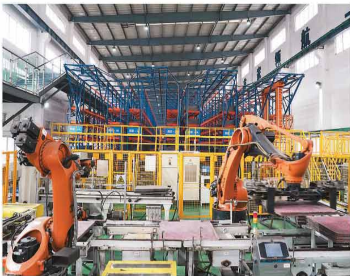
位于江西省的江铜集团贵溪冶炼厂智能化电解车间内，机器臂进行铜板转运作业。 新华社记者 万象摄
