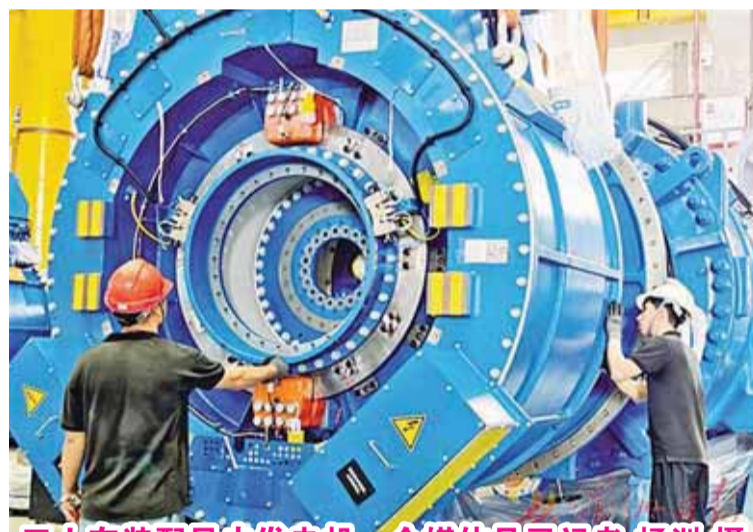
工人在装配风力发电机。全媒体见习记者 杨洲摄
